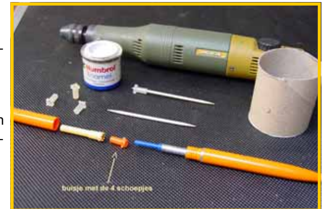
Links voor het verfpotje liggen nog een drietal gardebuisjes uit ander ballpoints. Rechts naast verfpotje een complete garde.
